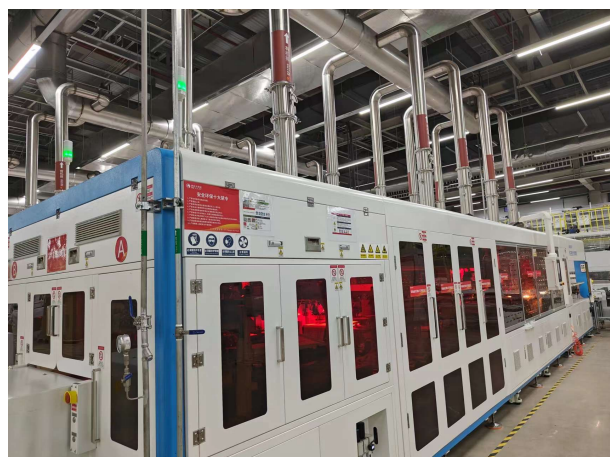
划焊一体机废气收集
