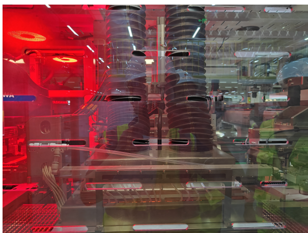
划焊一体机废气收集
