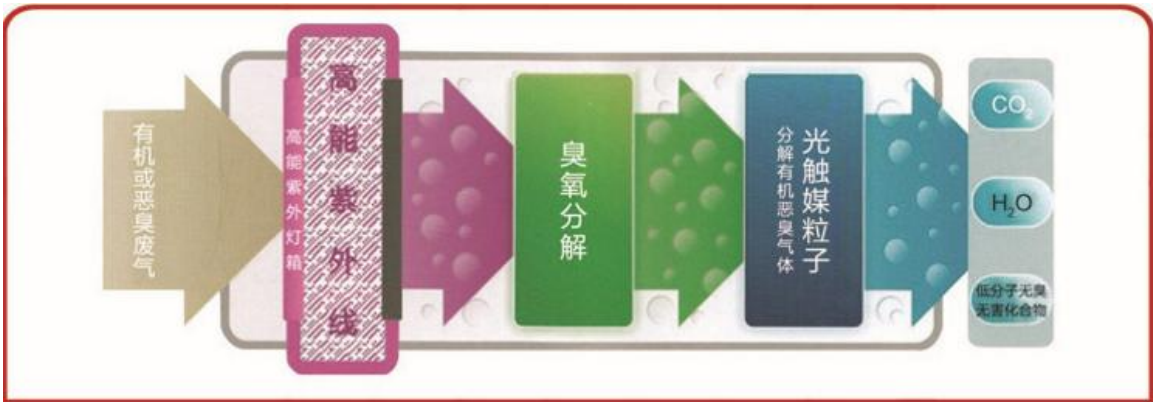
图 3-2 uv 光催化氧化设备工作原理图
